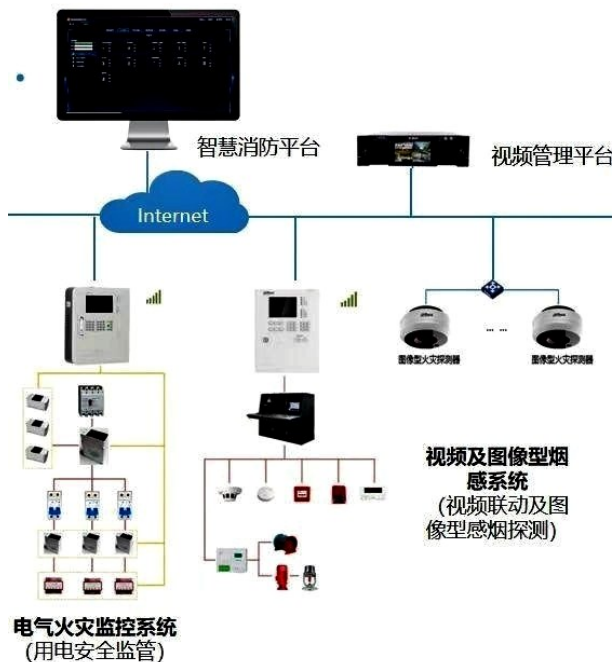
图4 智能家居火灾视频监控管理系统架构示意图
